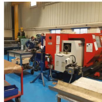
**Usinage d'embouts de vis à billes**
