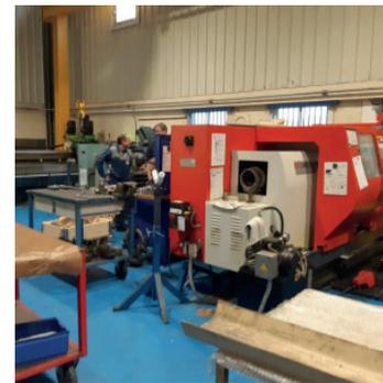
**Usinage d'embouts de vis à billes**
